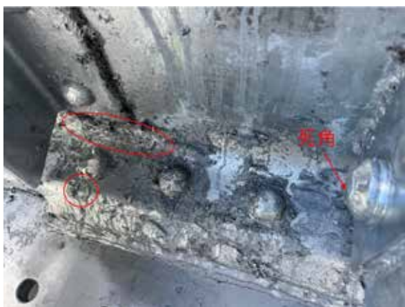
圖 10 鉚合鋼 I 梁豎向加勁板處積鋅、鋅渣 圖 11 鉚合面鋅液進不去無鍍鋅，容易流出銹水
