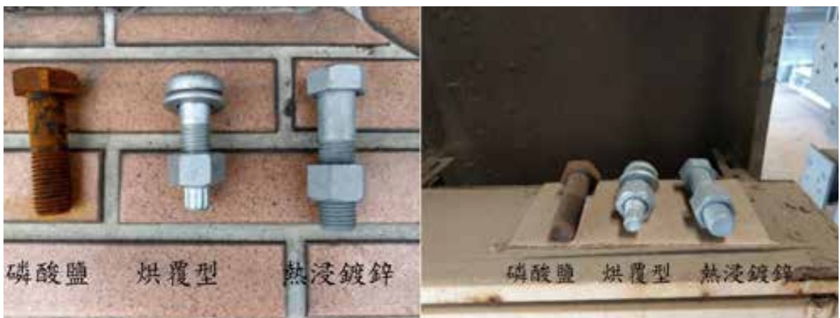
圖 6 磷酸鹽螺栓放置一個月 4 天已生銹，（左）戶外（右）工廠內
