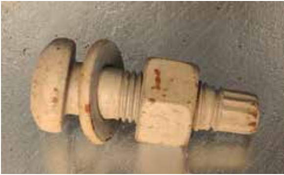
圖 9 烘覆型螺栓最初生銹位置
