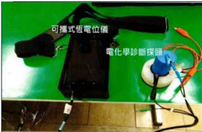
圖 2 (a) 可攜式 EIS 分析設備外觀，(b) 大氣曝曬現場量測塗層 EIS
