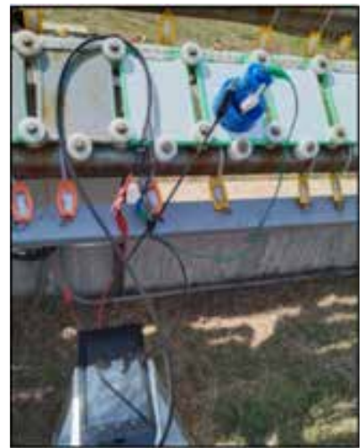
圖 2 (a) 可攜式 EIS 分析設備外觀，(b) 大氣曝曬現場量測塗層 EIS
