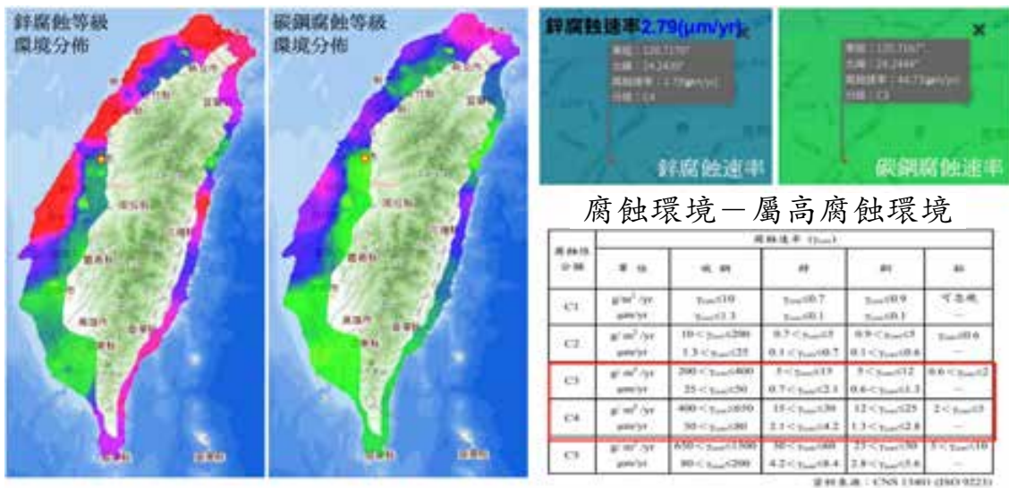
圖 8 工址周邊腐蝕環境調查
