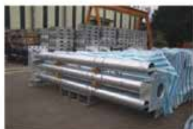
高鐵輸配電鋼架
