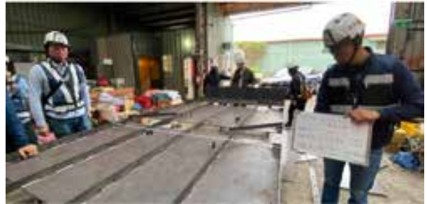
圖 10 設計構件及銲道尺寸查驗
