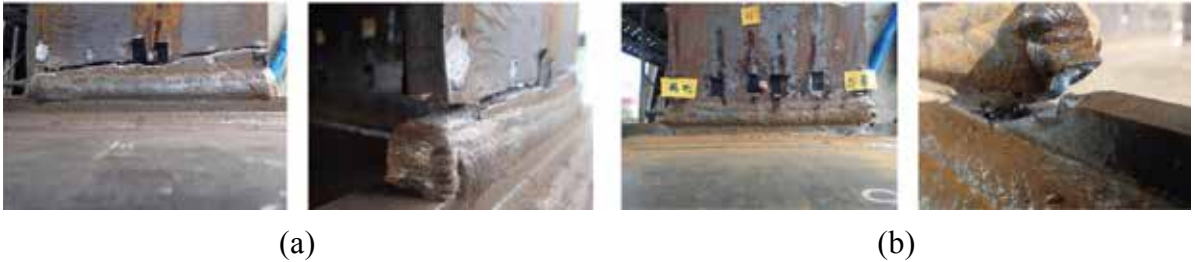
圖 5 破裂模式 (a) 梁翼板 :GTC25-S，(b) 隔板 GTC16-M
