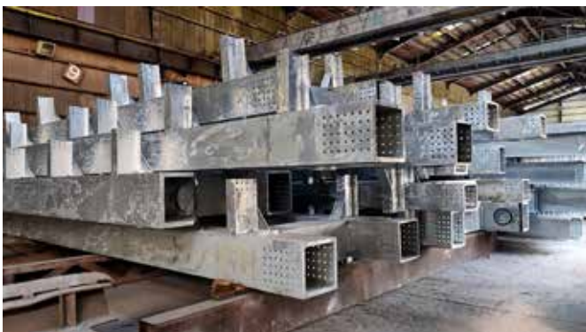
圖 5 熱浸鍍鋅完成
