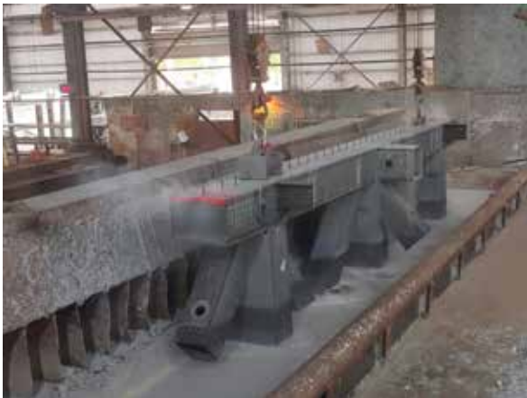
圖 3 熱浸鍍鋅 - 最大尺寸： 600×500×1.6m×3m×1m×11m 單重約 15.5 噸。因寬度超過鍍鋅爐尺寸，故 需兩次鍍鋅，紅色油漆為後續銲接處。
