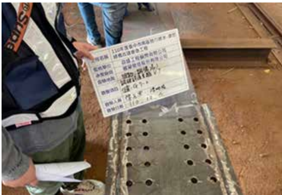
圖 7 構件加工後表面檢查
