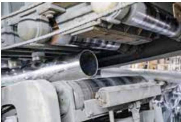
圖 7 自動化鋼管鍍鋅
