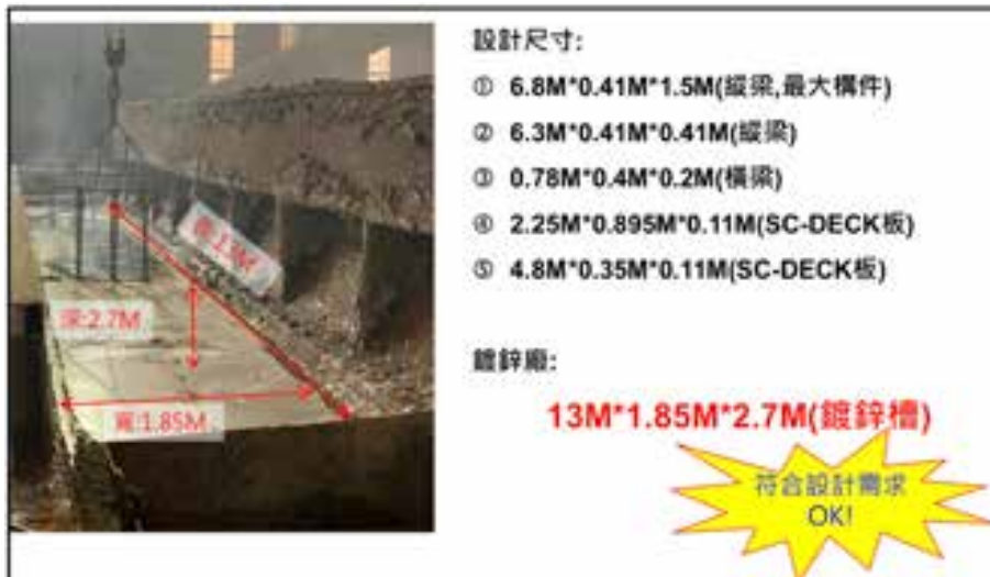
圖 6 鍍鋅槽與設計構件尺寸確認調查
