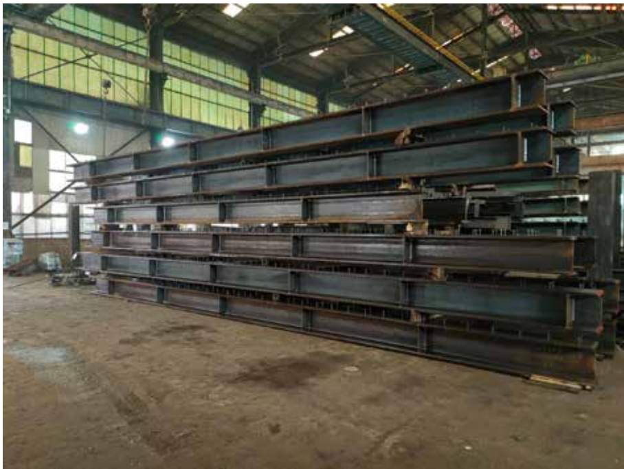
圖 3 H 型鋼鋁 428x407x35mmx9m-11.5m 採用 SN400B 鋼材
