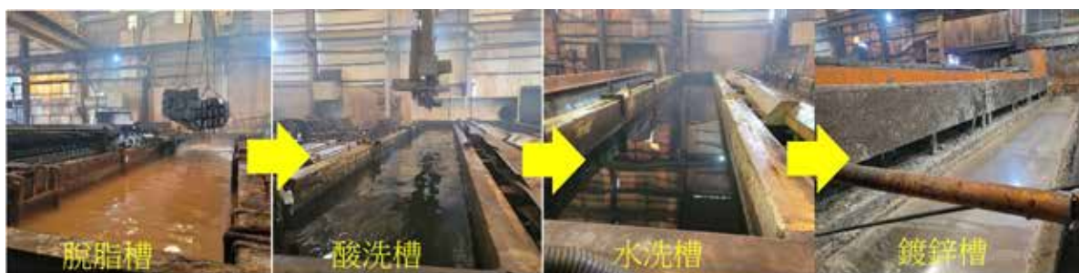
圖 3 鋼構件熱浸鍍鋅處理流程
