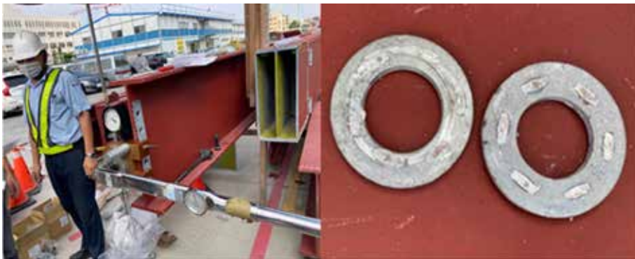
圖 7 直接張力指示器組螺栓，扭力鎖固驗證，華司壓縮
