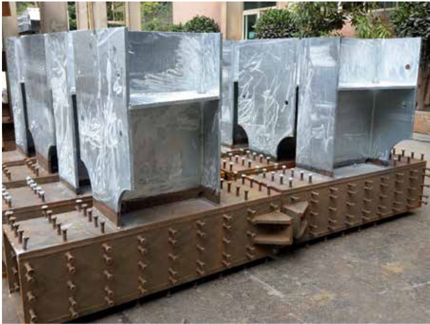
圖 6 因箱型梁為水泥灌漿，故不熱浸鍍鋅，單重約 1.04 噸
