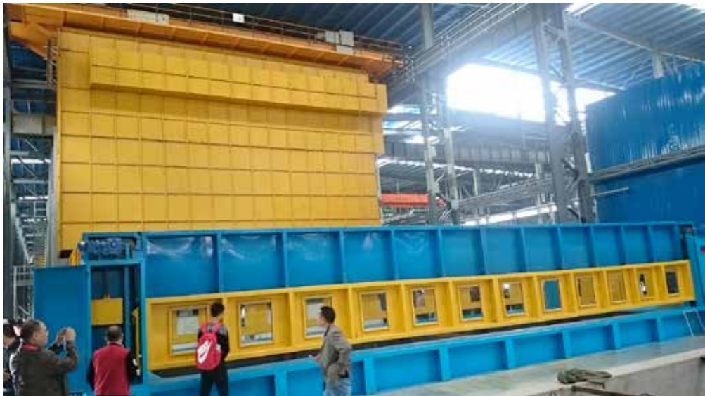
江蘇國強鍍鋅實業公司新設 13m×3.2m×4m 鍍鋅槽生產線
