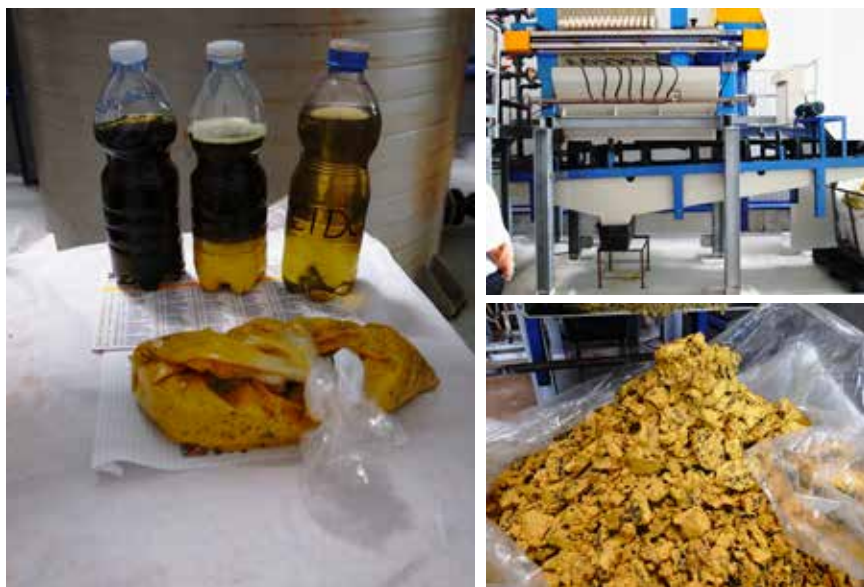
圖 2. 左圖從左到右瓶中，分別為廢酸、反應中的廢酸（已經有沈澱物）、回收酸； 右下圖為經壓濾機固化後的氧化鐵污泥。
