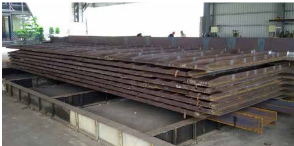
圖 7. 免拆鋼模板 (鍍鋅前)
