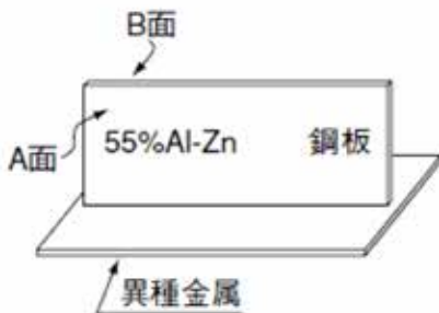
圖 7. 熱浸鍍 55% 鋁鋅鋼板與異金屬進行鹽霧試驗 [ 3 ]
