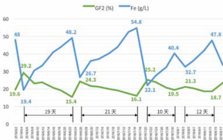
圖 4. 磷酸複合酸洗液 (GF2) 濃度控管。
