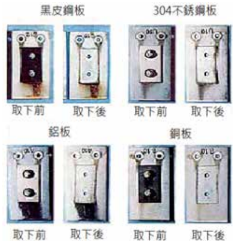
圖 6. 暴露後接觸鋼板取下前後之試片外觀〔5〕
