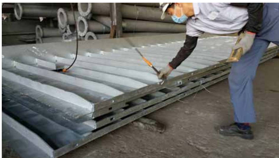
圖 8. 免拆鋼模板經熱浸鍍鋅處理
