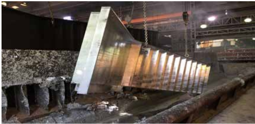
圖 4. 熱浸鍍鋅作業
