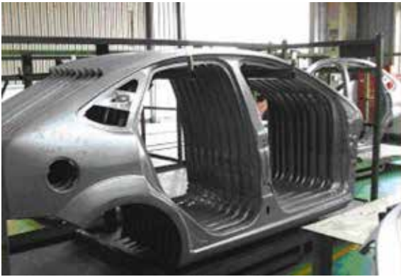
圖 6、使用 JAC270E GA 鋼片衝模加工之 BODYSIDE 半成品照片
