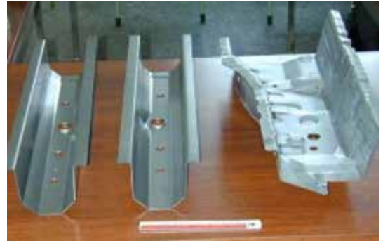
圖 11、使用 JAC590Y 衝模加工之橫梁照片
