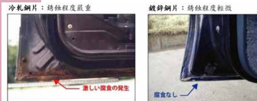
圖 1、北美地區車齡 8 年汽車之車門底緣銹蝕狀況比較 (3)
