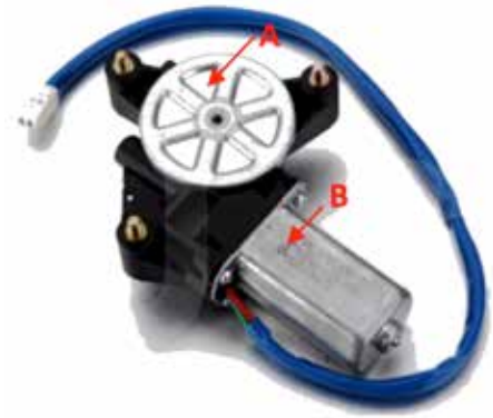
圖 7、使用 DX51D( 部件 A) 及 DX53D ( 部件 B) GI 鋼片生產之車窗馬達外殼件
