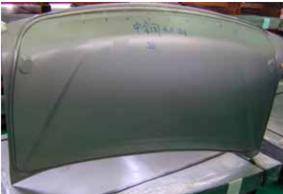
圖 8、使用 JAC340H GA 鋼片衝模加工之引擎蓋半成品照片
