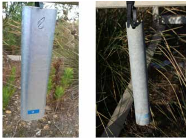
圖 3、環保鈍化處理後 28 個月，左邊外觀亮麗，右邊明顯白銹。
