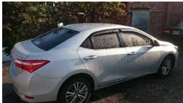
圖 6、2017.12.23 晚上晴天濕度達 99%。冬、春天早上容易結露，影響噴砂、噴漆作業
