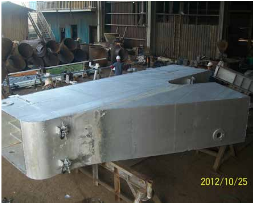
圖 5、兩端拱肋高度高於鍍鋅槽深度，採用兩次鍍鋅方式
