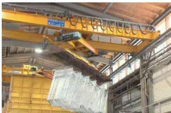
圖 17、透過可旋轉 180 度的天車，克服場地限制
