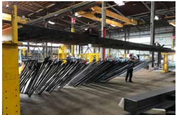
圖 14、工人吊掛工件上架
