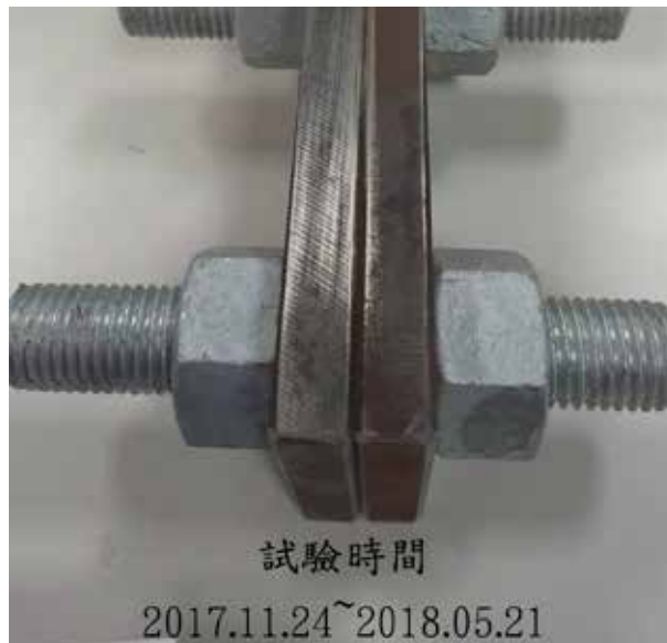
圖 3、鎖緊扭力 175N-m，半年後無氫脆現象
