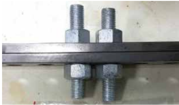
圖 2、鎖緊扭力 175N-m，48 小時後無氫脆現象
