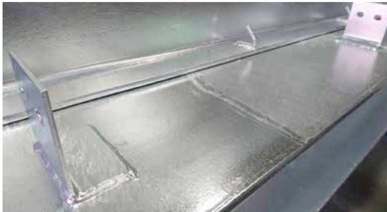
圖 5、型鋼固定板密封銲接，可得到良好的鍍鋅品質
