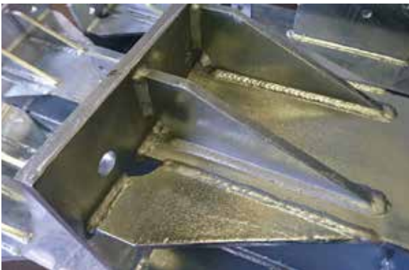
圖 3、銲渣清除乾淨可獲漂亮鍍層
