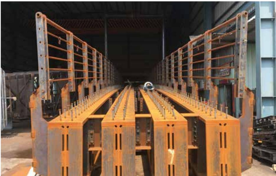
圖 3、鋼橋預組立後的照片 (正面)
