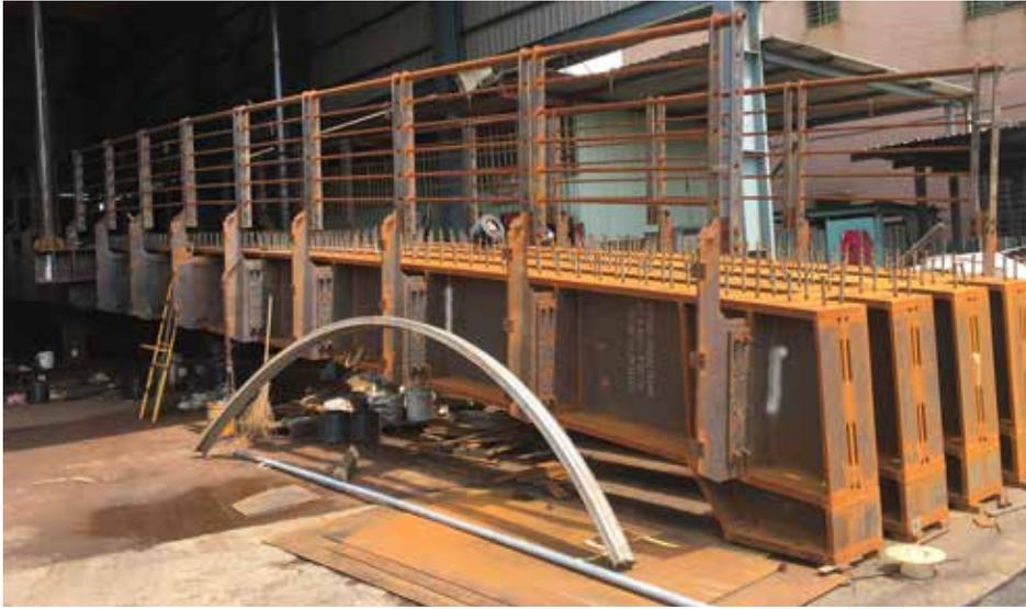
圖 2、鋼橋預組立後的照片 (側面)
