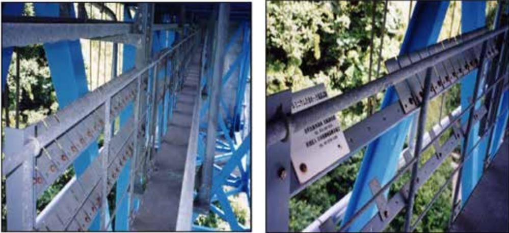
圖 10、在橋 N 附近的檢修通道設置了暴露測試樣品
