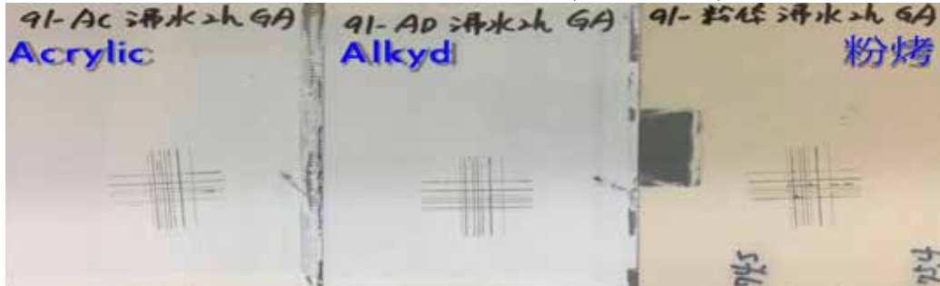
圖 13 二次密著試驗結果(沸水/2小時)
