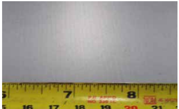
圖 6 GA 鉻酸鈍化皮膜材表面外觀
