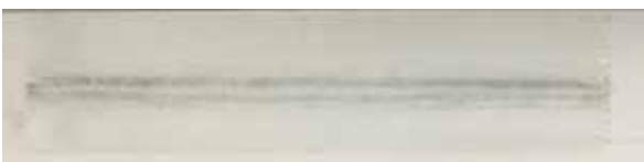
圖 7 GA 無鉻型鈍化皮膜材 90° V 型彎曲試驗膠帶黏貼結果
