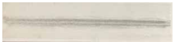
圖 8 GA 鉻酸鈍化皮膜材 90° V 型彎曲試驗膠帶黏貼結果
