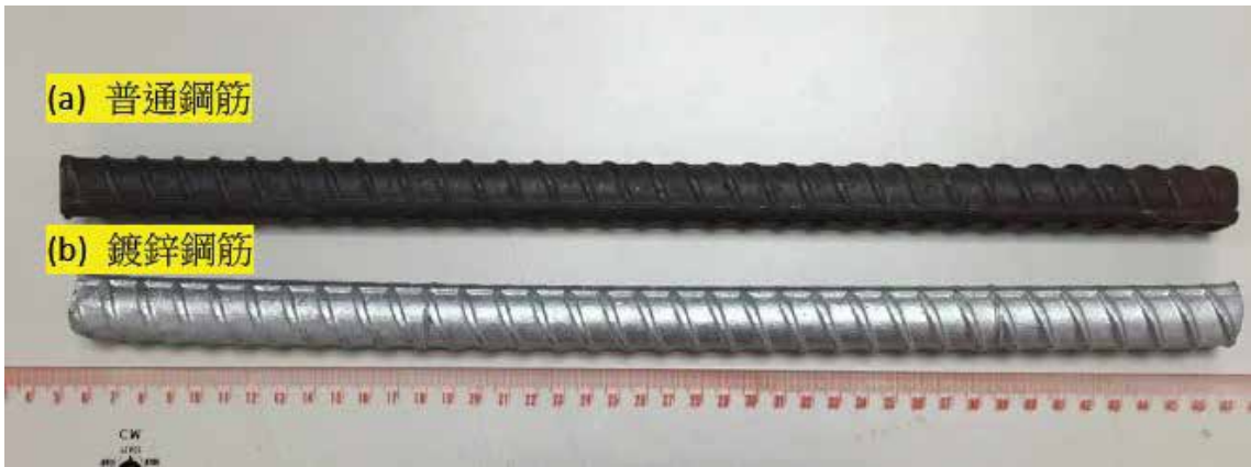
圖 2、普通鋼筋及鍍鋅鋼筋外觀
