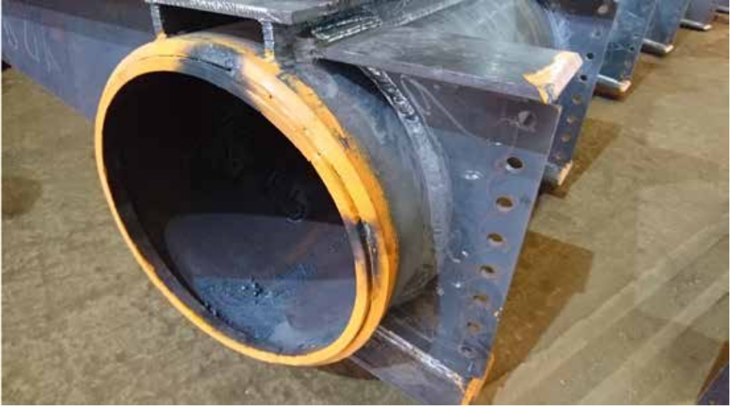
圖 4、管口塗漆部分為銲接處，避免鋅鍍上
