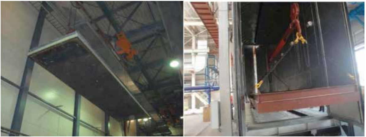
圖3、正常鋅浴爐是以起重機來操作作爐蓋與鍍件
