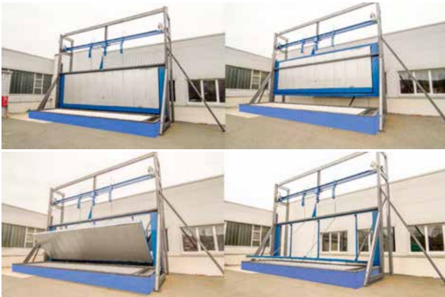
圖 6、顯示在既有的鍍鋅爐上改裝集成爐蓋的測試運行
