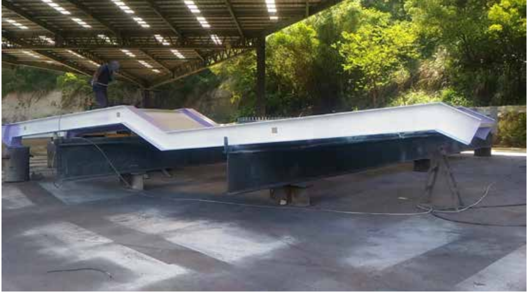
圖 10、熱浸鍍鋅完成後再塗三道漆 (90 \mu\text{m} 以上)
