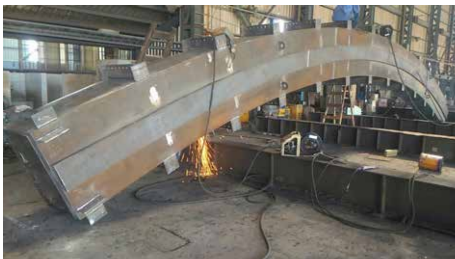
圖 3、弧形箱梁，尺寸 1m × 0.7m × 15m，重量約 16 噸
