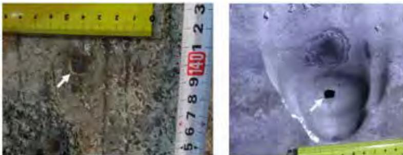
圖 4、鋅鍋局部孔蝕外觀 (左：外壁，右：內壁)
