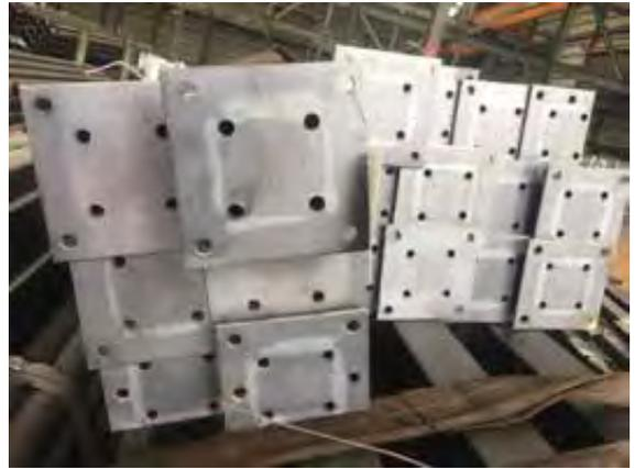
圖 12、方形管柱洩鋅孔
