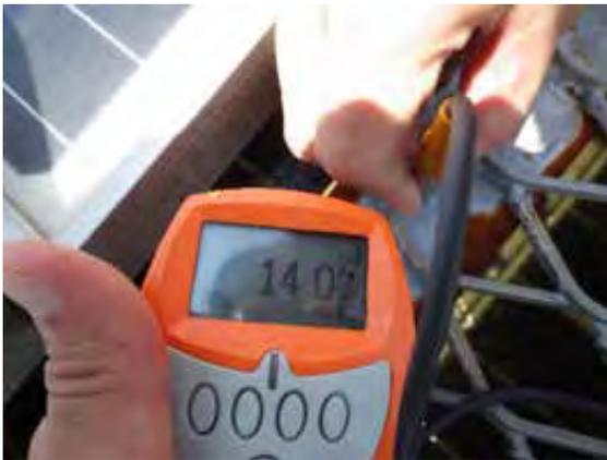
圖 19、桁條膜厚度量測
