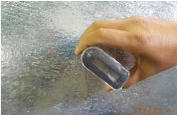
圖 5、拱圈膜厚 99.0 \mu\text{m}
