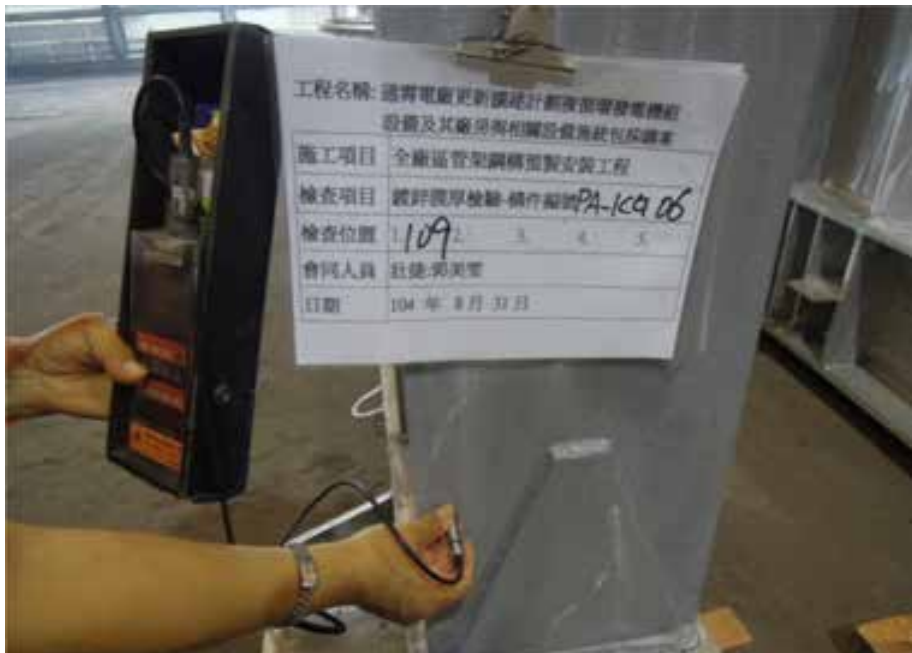
圖 5 管架鋼構鍍鋅層膜厚量測。
