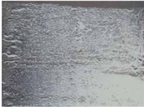
圖 4 TRIP-B 鋼材在露點 0 °C 退火 60 s 後，於 0.28Al/0.28Mg 鋅浴中鍍鋅 3 秒後的鍍層外觀。
