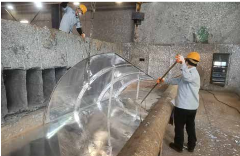
圖 4 橋墩防撞鋼板熱浸鍍鋅。
