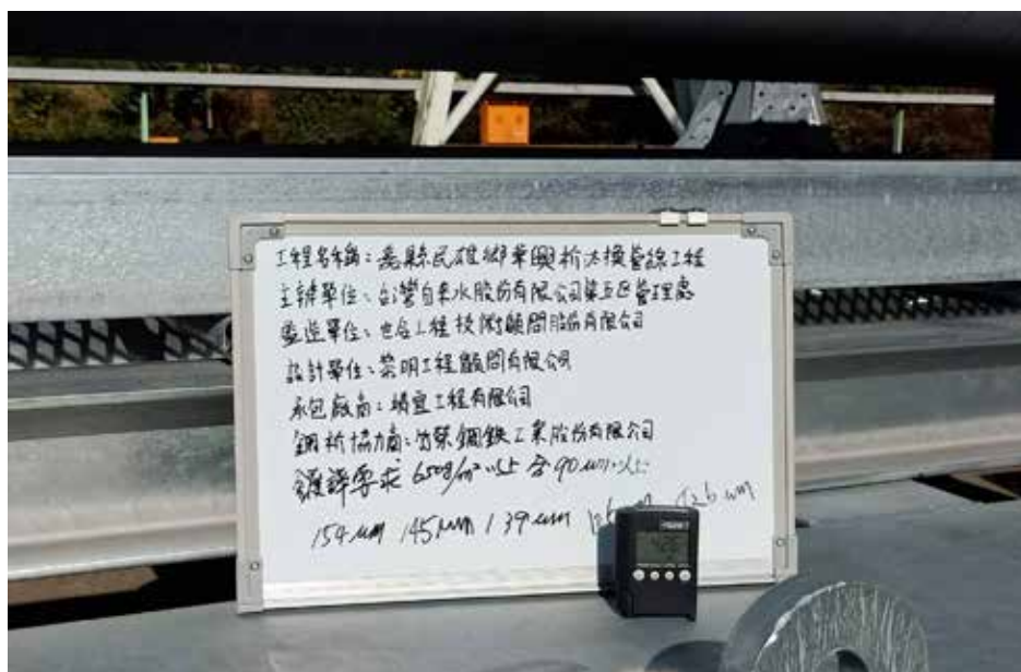
圖 9 量測熱浸鍍鋅膜厚。
