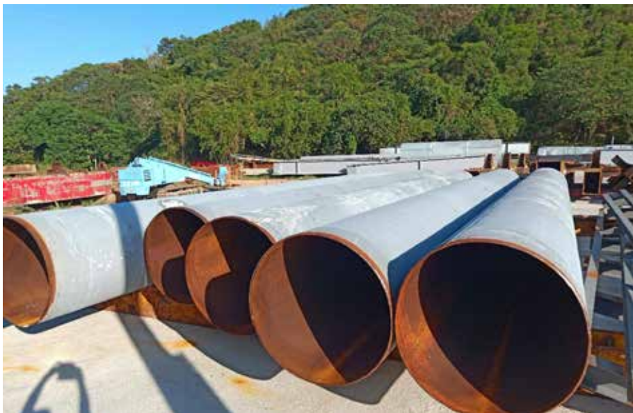
圖 8 輸水管 - 管徑 1000mm。 外鍍內不鍍 (由易宏熱鍍鋅工業鍍鋅處理)
