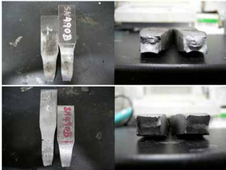
圖 3、SN490B (a) 未經熱浸鍍鋅與 (b) 經熱浸鍍鋅斷裂試棒之俯視圖及破斷面
